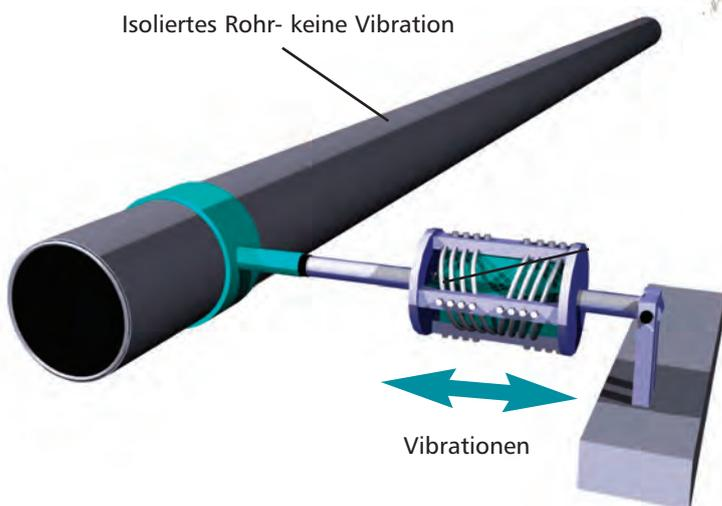
Das Drahtseil wird jeweils um 90° durch die Stege fixiert. Durch die konstruktive 2er Teilung der Aufnahmeplatte wird eine Verwindung oder Verdrehung des Drahtseils verhindert.
