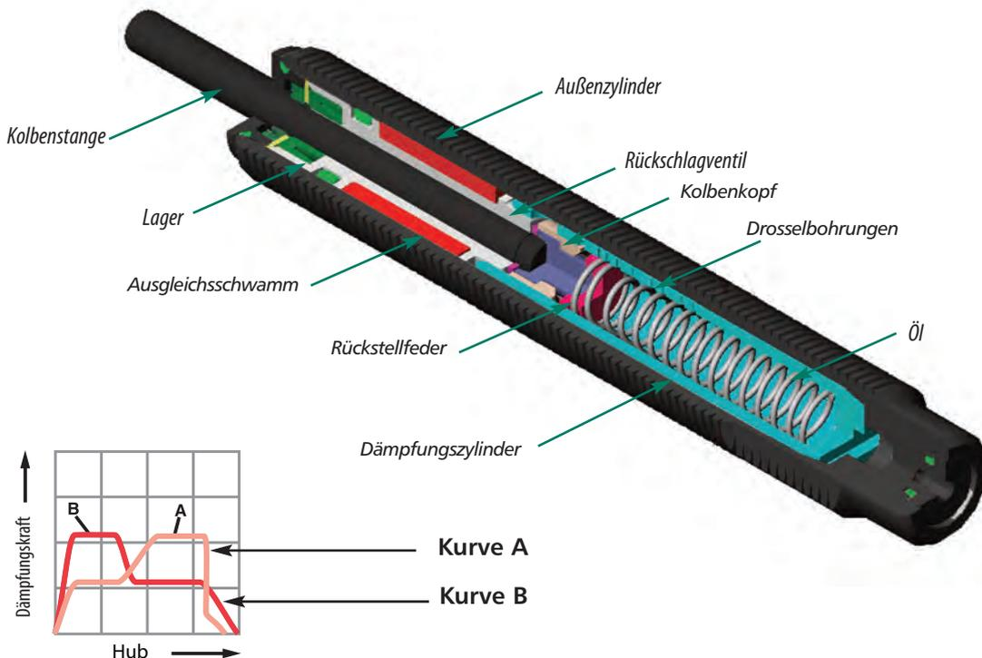
**Selbstkompensierende Dämpfungscharakteristik** Bei selbstkompensierenden Stoßdämpfern sind die Drosselbohrungen so angeordnet, dass bei variierenden Massen und Geschwindigkeiten ein zufriedenstellendes Abbremsen erreicht wird. **Kurve A:** große Masse, niedrige Geschwindigkeit **Kurve B:** kleine Masse, hohe Geschwindigkeit
