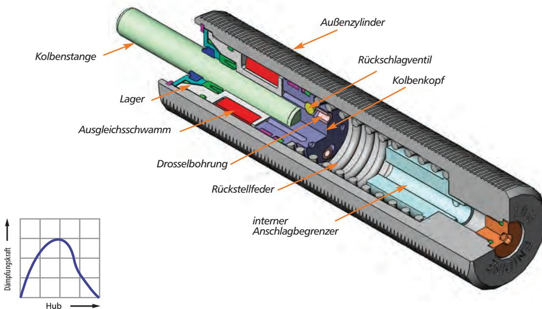
Eine über den Hub konstant bleibende Drosselfläche erzeugt eine hohe Gegenkraft am Anfang des Hubes (**degressive Dämpfung**). Derart konzipierte Stoßdämpfer ermöglichen eine hohe Energieaufnahme bei kleinstmöglichem Bauraum.
