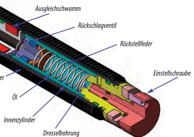
der Kolbenstange. Ohne diesen Schwamm wäre der Dämpfer hydraulisch blockiert. Aufgrund der über den Hub konstant bleibenden Drosselöffnung wird nach dem Aufprall eine relative hohe Stützkraft erzeugt, die dann über den Hub abnimmt. Diese Ausführung ist auch in fest-eingestellten Versionen erhältlich.
