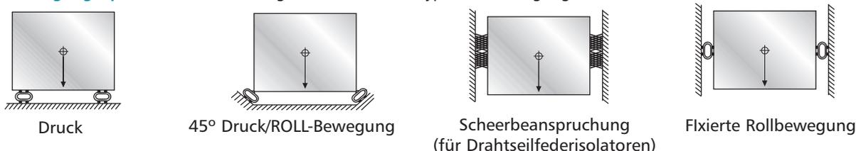
**Stabilisatoren:** Stabilisatoren werden eingesetzt um bei relativ schlanken Massenverhältnissen die Auslenkung zu kontrollieren. Stabilisatoren werden empfohlen wenn das Höhen-/Breiten-/Tiefen- Verhältnis größer 2 ist. Bei den meisten Anwendungen entspricht die Anzahl der erforderlichen Stabilisatoren der Hälfte der im Normalfall verwendeten Drahtseilfedern, diese Drahtseilfedern werden eine Stufe weicher als beim Normaleinsatz (der Drahtseilfeder) ausgewählt.
