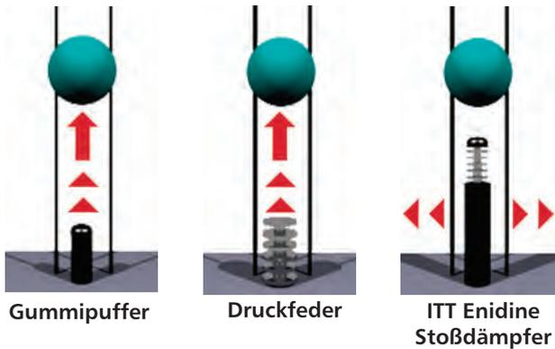
Alle bewegten Objekte besitzen Energie. Die Energiemenge ist abhängig von Masse und Geschwindigkeit. Um eine bewegte Masse zum Stillstand zu bringen, muss ein mechanisches Bauteil verwendet werden, welches eine Kraft entgegen der Bewegungsrichtung erzeugt.
