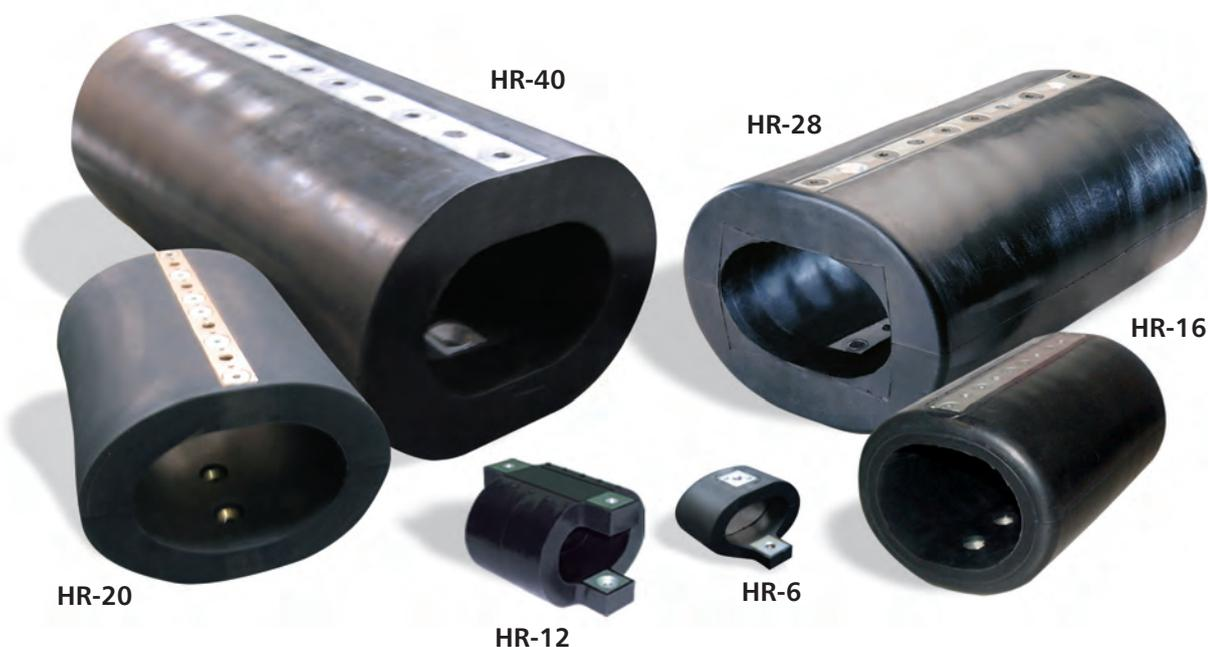
Der HERM Isolator ist eine Weiterentwicklung der traditionellen ITT Enidine Drahtseilfeder mit einer schützenden Elastomerumhüllung. Das rostfreie Kabel verbunden mit den Befestigungsleisten gewährleistet eine mechanisch robuste Konstruktion, wobei das umhüllende Elastomer eine zusätzliche Dämpfung und Steifigkeit erzeugt. Diese Konstruktion ermöglicht ein absolut betriebssicheres System mit einer höheren Steifigkeit und somit einer höheren Energieabsorptionsfähigkeit.
