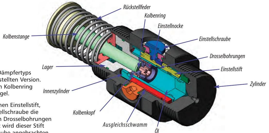
Die Low velocity Range (LR) Serie ist ausgelegt um Geschwindigkeiten zu kontrollieren die geringer sind als bei der einstellbaren Standardauswahl.
