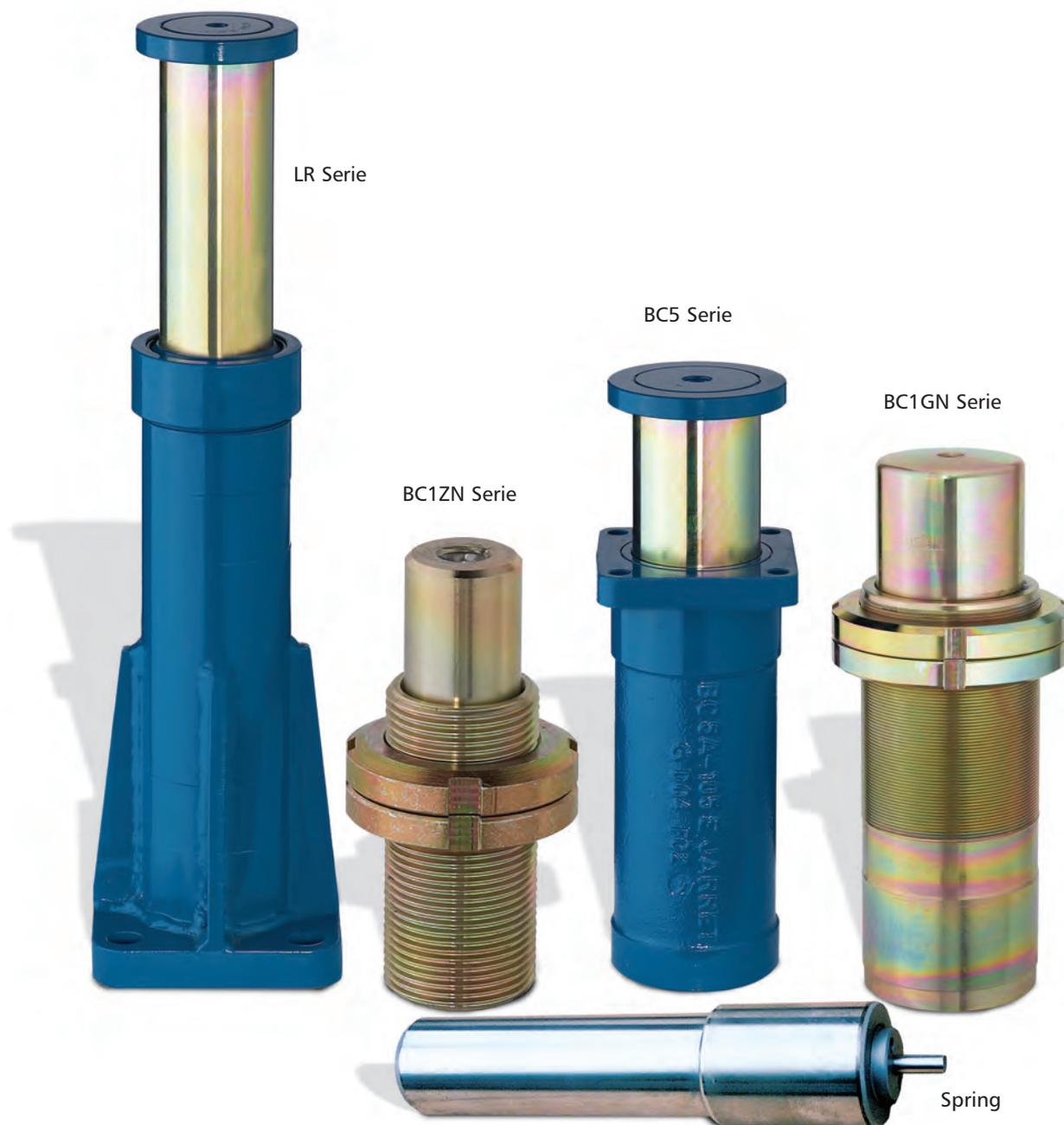
Jarret Stoßdämpfer funktionieren nach dem Prinzip der hydrostatischen Kompression von Elastomeren. Die Viskosität und die Kompressibilität der Silicon Elastomere bedürfen keiner komplizierten mechanischen Vorrichtungen, wie Rückhol oder Vorspannsysteme. Die Rückstellung des Kolbens erfolgt durch das Entspannen des komprimierten Elastomers.
