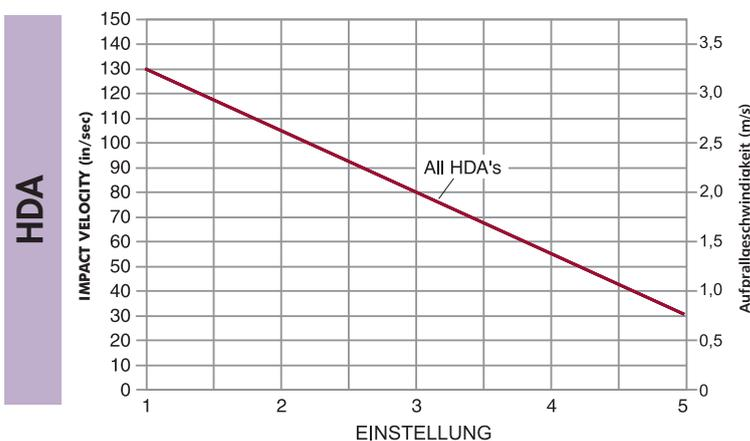
Nach der korrekten Dimensionierung eines HDA-Stoßdämpfers, kann der Einstellbereich für die Anwendung bestimmt werden:
