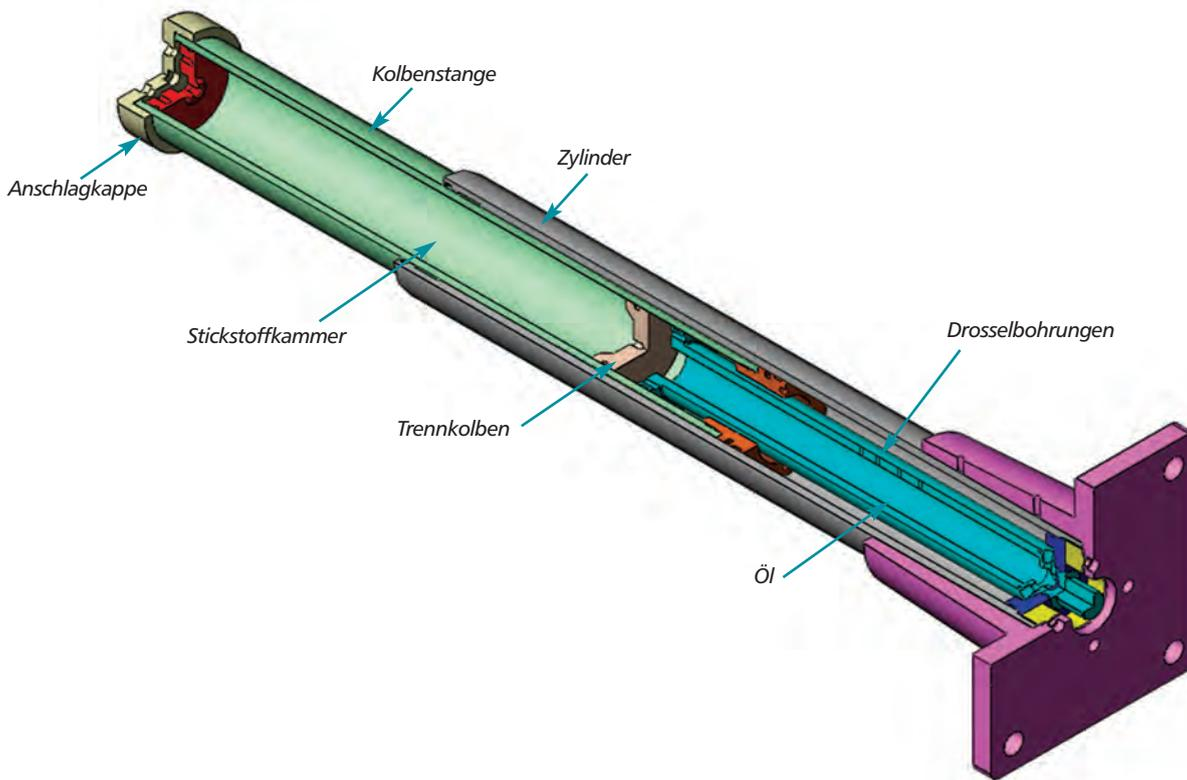
**HI Modelle** basieren auf dem System eines konzentrisch zum Außenzylinder eingebauten Innenzylinders, in den in der Längsrichtung verteilt einzelne Drosselbohrungen eingebracht sind. Während der Kolbenbewegung nach dem Aufschlag des Bewegungsobjektes wird das im Innenzylinder befindliche Öl über die Drosselbohrungen in die mittels Stickstoff vorgespannte Hohlkolbenstange verdrängt. Während der Kolbenbewegung wird durch Überfahren der Drosselbohrungen die Drosselfläche verringert.
